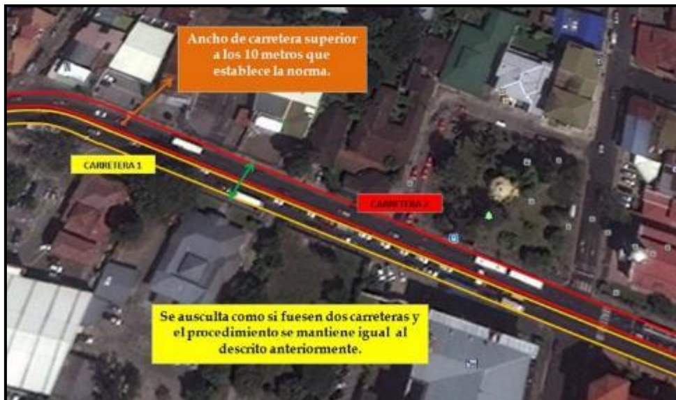
Figura 6.8 Procedimiento para carreteras anchas
